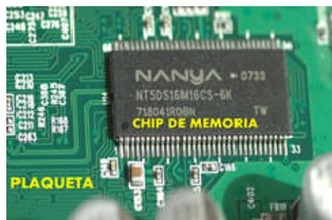
Figura 1. Chip de memoria y plaqueta, placa de circuitos o tarjeta madre (en color verde)
